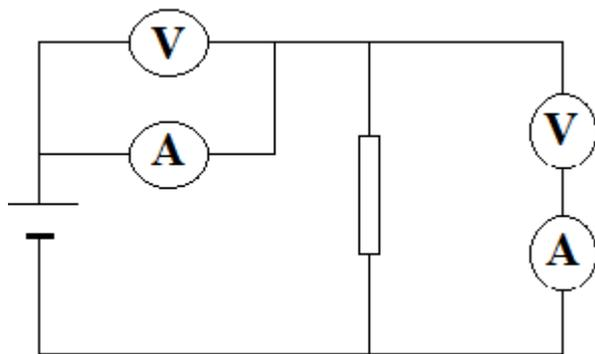
Рассматривая параллельное соединение вольтметра и миллиамперметра (прибор № 2) можно сделать вывод, что при токе  $I_2 = 7 \text{ мА}$  напряжение на миллиамперметре –  $U_2 = 0,3 \text{ В}$ , следовательно, при токе  $2,7 \text{ мА}$  напряжение на нем составит:  $U' = \frac{0,3 \cdot 2,7}{7} = 0,116 \text{ В}$ .
